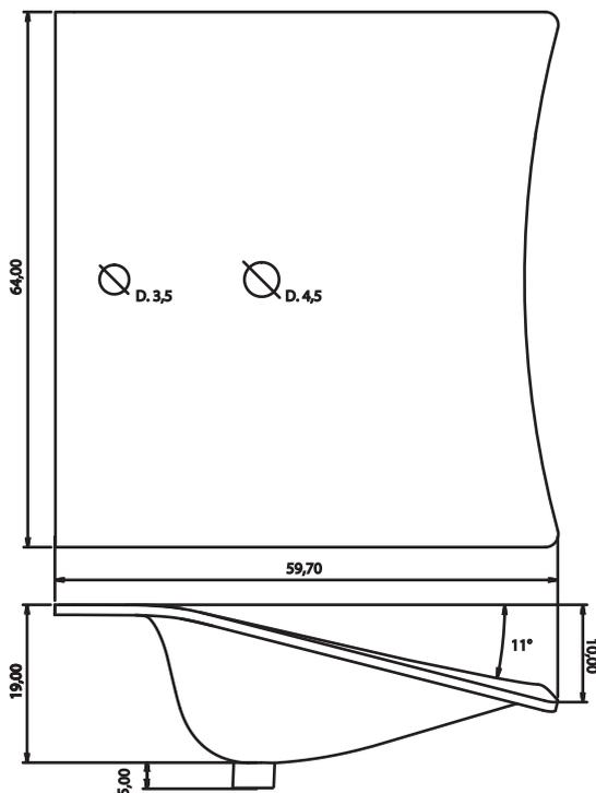
Lavabo monoscocca di uso universale, realizzato in unica lastra di Corian 12 mm, dotato di piano con poggiagomiti inclinato di 11° e bordo anteriore concavo per favorire l'avvicinamento e le manovre di rotazione su sedia a rotelle. Fornito preassemblato, completo di troppo pieno in ottone cromato e di staffa di fissaggio in acciaio zincato e verniciato con 4 punti di ancoraggio a parete. Peso totale 12 Kg. Capacità di carico 150 Kg.
